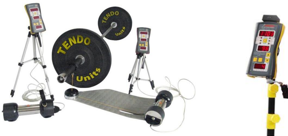
1.13-súwret. Tendo Sport Power háreket tezligi hám kúshin ólshew qurılması.
